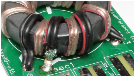
Afbeelding 8. Detail. Zwart is de 3 windingen secundaire wikkeling. Deze is tussen de primaire windingen in gewikkeld. De 80m aftakking "sec1" is na 1 winding. Daar loopt met 400W vermogen 26A HF stroom door ! Dus ook door de serie resonantie condensatoren.
