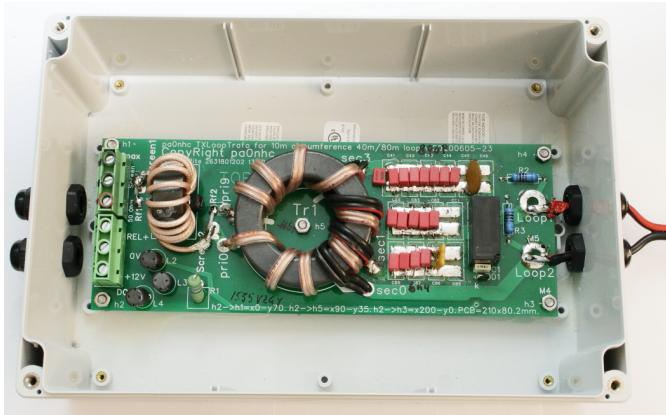
Afbeelding 7. Versie2 van de aanpas box. Beide ferriet kernen haaks op elkaar geplaatst.
