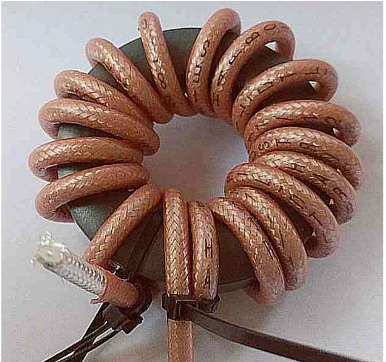
Afbeelding 6: Coaxiale ringkern CMC met 18 windingen RG400 over 61mm #31 kern.
